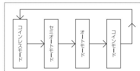
本製品でコイン不要機のオートモードからコインモードに移行した場合、本製品がコインモードでのリールストップに対応していないため、このリモコンから実機を操作することができません。
